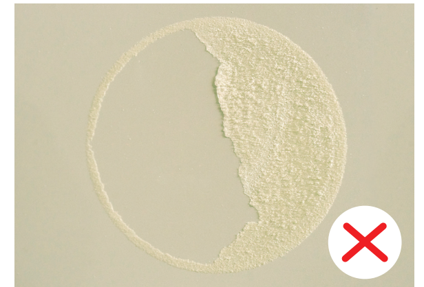
Lớp cách nhiệt bám dính trên sơn mặt sau thông thường Insulation adhesion on conventional pre-painted steel backer
